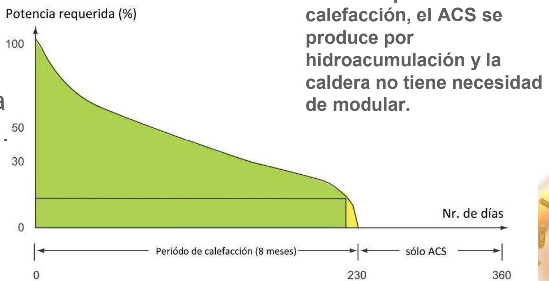
Fuera del período de calefacción, el ACS se produce por hidroacumulación y la caldera no tiene necesidad de modular.
